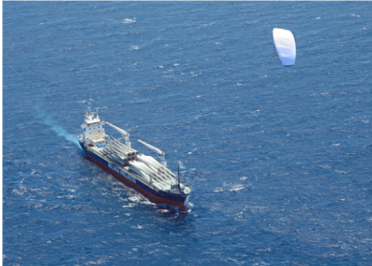
Das SkySails-System im Betrieb auf dem MS "Beluga SkySails"
